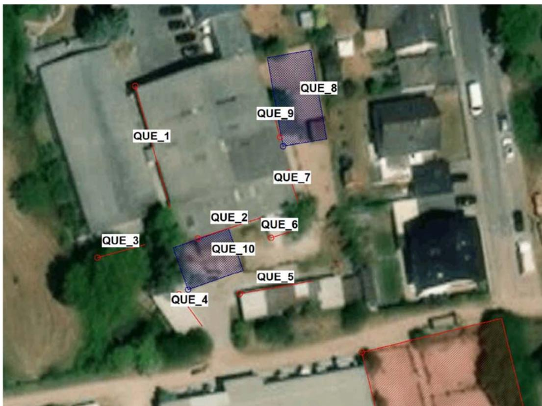
Abbildung 5: Lage der Emissionsquellen, nördliches Betriebsgelände
